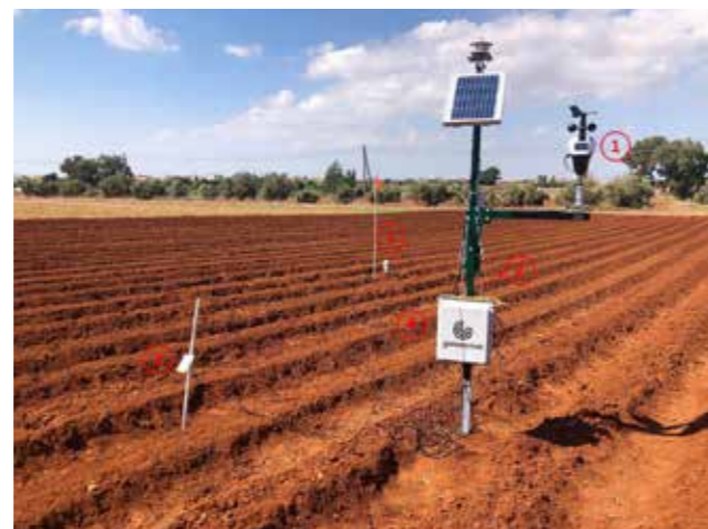
Εικόνα 1: Εγκατάσταση εξοπλισμού στο πιλοτικό αγροτεμάχιο (1: Ατμοσφαιρικοί αισθητήρες, 2: Πολυαισθητήρες φυτού/φυλλώματος, 3: Πολυαισθητήρας εδάφους, 4: Κέντρο ελέγχου-αυτοματισμοί)
