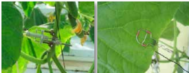
Εικόνα 1: Αισθητήρες μέτρησης μεταβολής διαμέτρου βλαστού (mm) και θερμοκρασίας φύλλου ( ^{\circ}\text{C} )
