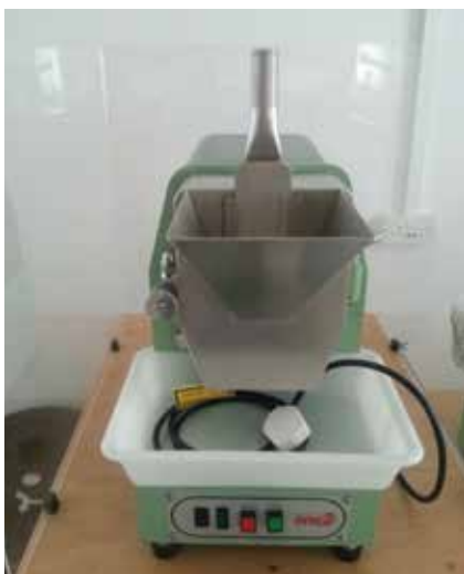
Εικόνες 3-5: Εξοπλισμός (σπαστήρας, θερμομαλακτήρας, φυγόκεντρος) εργαστηριακού ελαιοτριβείου Abencor
