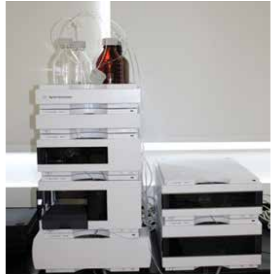
Εικόνα 10: Σύστημα Υγρής Χρωματογραφίας με ανιχνευτές φωτοδιάδων (PDA) και δείκτη διάθλασης (RID) για προσδιορισμούς βιοχημικών δεικτών ποιότητας στον ελαιόκαρπο και στο ελαιόλαδο
