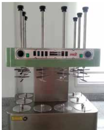
Εικόνες 3-5: Εξοπλισμός (σπαστήρας, θερμομαλακτήρας, φυγόκεντρος) εργαστηριακού ελαιοτριβείου Abencor
