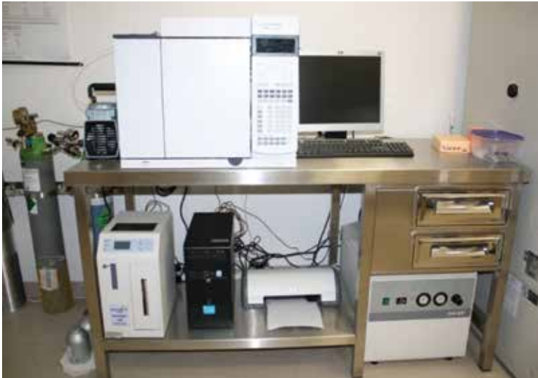
Εικόνα 9: Σύστημα Αέριος Χρωματογραφίας με ανιχνευτή ιοντισμού φλόγας (FID) για διαχωρισμό και ποσοτικοποίηση των λιπαρών οξέων σε ελαιόλαδα
